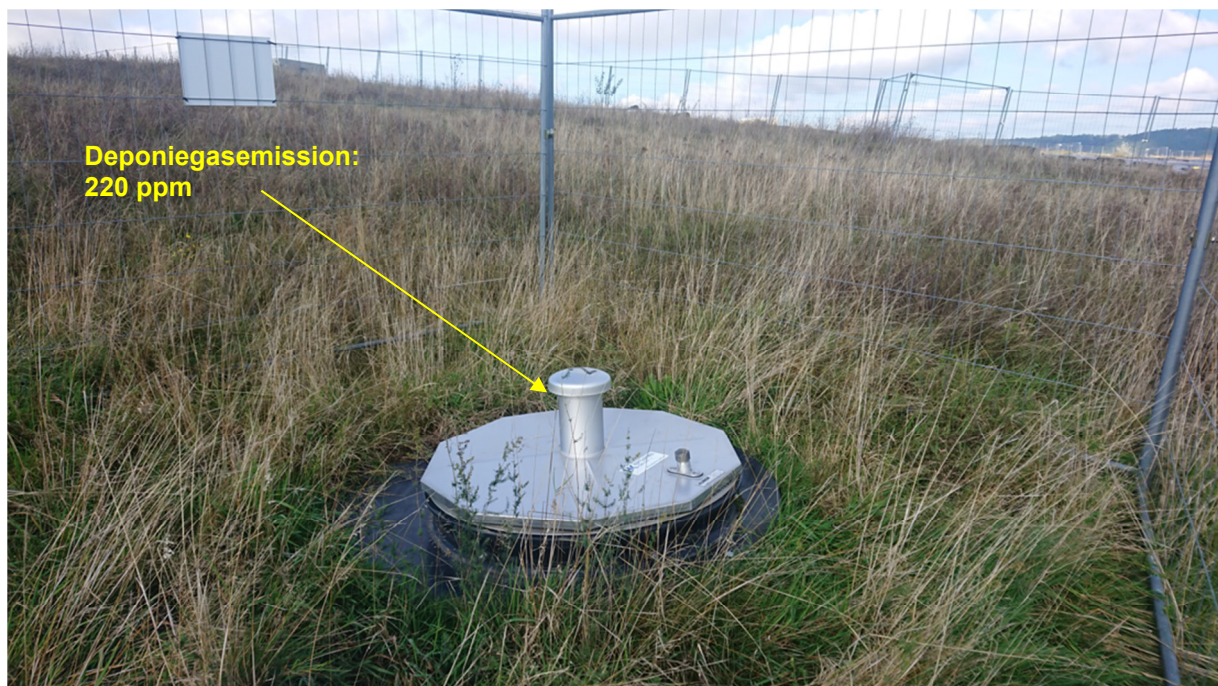
Bild 2: südlicher Deponiebereich, Gasbrunnen 2
