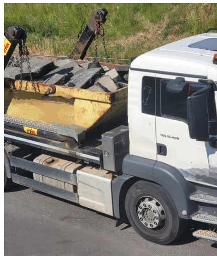
Bild: Zurückweisung von teerhaltigem Straßenaufbruch aufgrund Übergröße (größer 50 cm Kantenlänge)
