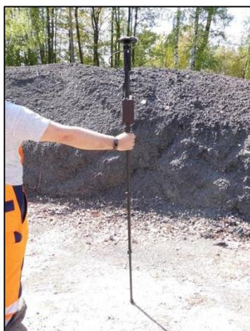
Foto: GPS-Positionsbestimmungsgerät MagicMapper im Einsatz (Bestimmung des Ablagerungsortes)
